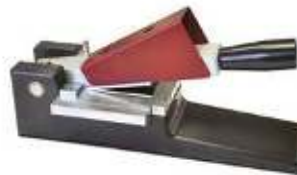
专用折痕和纸板样品切刀 准备折痕和挺度样品
